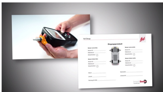
Die Daten der Universalsensoren werden mit dem RDKS-Diagnosegerät ausgelesen und zur Dokumentation in ein Eingangsprotokoll eingetragen.
