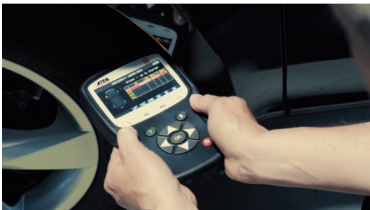
Das RDKS-Diagnosegerät VT56 ist ein Universalwerkzeug zum Auslesen, Konfigurieren und Programmieren aller IntelliSens-Universalsensoren.
