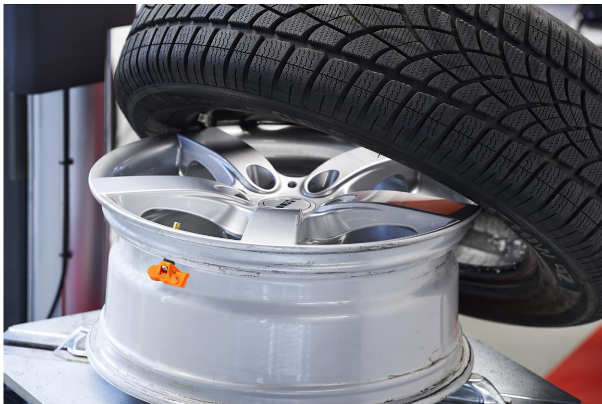
Die Montage eines Universalsensors IntelliSens von Huf.
